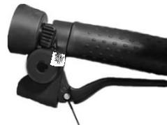
7. Insérez le guidon dans le tube de la batterie en respectant le sens indiqué ci-contre (cela ne doit pas forcer et doit glisser facilement). Les trous du guidon doivent être alignés avec les trous de la potence.
